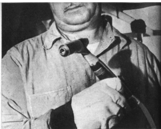
Le soudeur peut travailler en plein air avec ce chalumeau. Ce dernier porte deux ajutages concentrés qui projettent de l'argon sur la soudure, chassant l'air qui contaminerait le métal.
